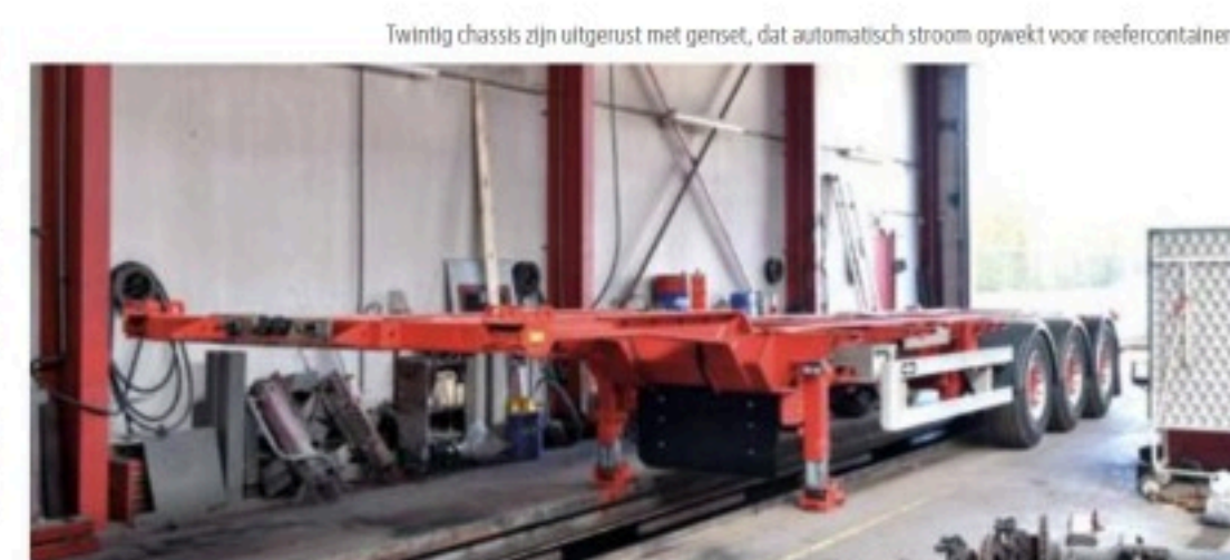
Twintig chassis zijn uitgerust met genset, dat automatisch stroom opwekt voor reefercontainers.
